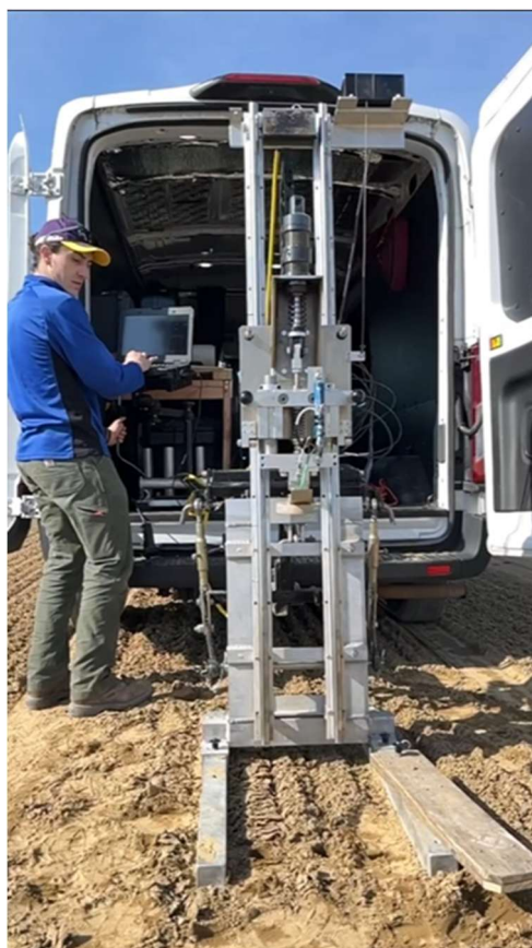
Figura 2: Medidor biomecánico de superficies Orono. Simula la mano líder de un caballo al galope, fuerzas y aceleraciones son registrados en tiempo real. Registra siete variables que se combinan para dar las cinco propiedades funcionales: firmeza, agarre, amortiguación, devolución de la energía y uniformidad.
